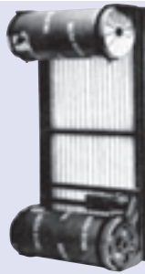
TROX o-mat F100 (11) Filtro rotativo para disposição de montagem universal 950 até 2.150 mm Largura do filtro: 950 até 2.150 mm Altura do filtro: 1.100 até 5.000mm Vazões: a partir de 8.100 m³/h Nº de folheto: F1001
