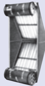
TROX o-mat F102 (12) Permite vazões superiores pela forma em "V" 950 até 2.150 mm Largura do filtro: 950 até 2.150 mm Altura do filtro: 1.100 até 3.000 mm Vazões: a partir de 10.100 m³/h Nº de folheto: F1001 (sob consulta)
