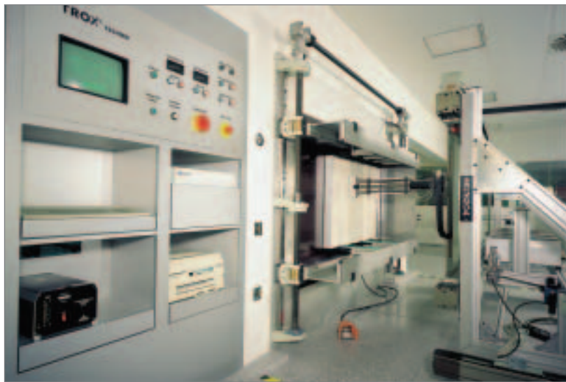
Photo 2: Test rig EN 1822-4
