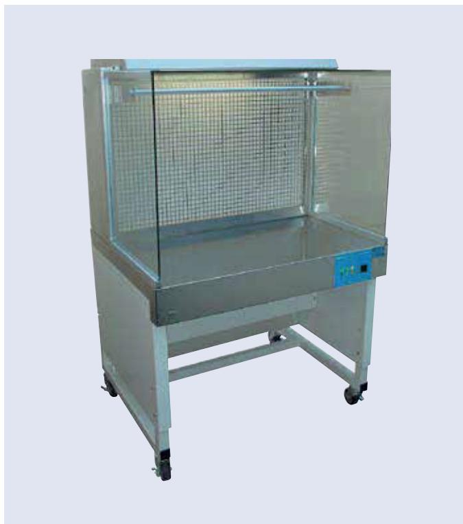
Os fluxos unidirecionais tipo FLH-KE são projetados para manipulação de materiais não contaminados e, na figura abaixo, pode-se ver o princípio de funcionamento deste equipamento. O ar do ambiente é pré-filtrado e impulsionado pelo ventilador para o filtro absoluto, que cria um fluxo de ar limpo.
