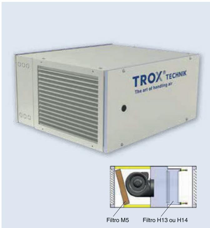
O equipamento TROX modelo IAE-EX permite à insuflação ou exaustão de ar. Composto por pré-filtro, ventilador e filtro H13 (ISO35H) ou H14 (ISO45H), destina-se ao insuflamento de ar estéril ou a exaustão de ar contaminado de quartos de isolamentos e outros compartimentos hospitalares. Foi projetado para uso interno e não deve ser instalado à intempéries.
