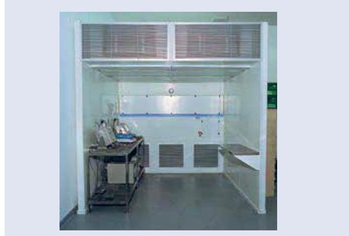
Cabine em aço galvanizado com pintura epóxi
