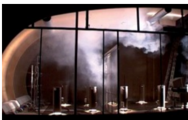
Testes de fluxo de ar: configuração Mock na pesquisa e desenvolvimento no laboratório TROX
